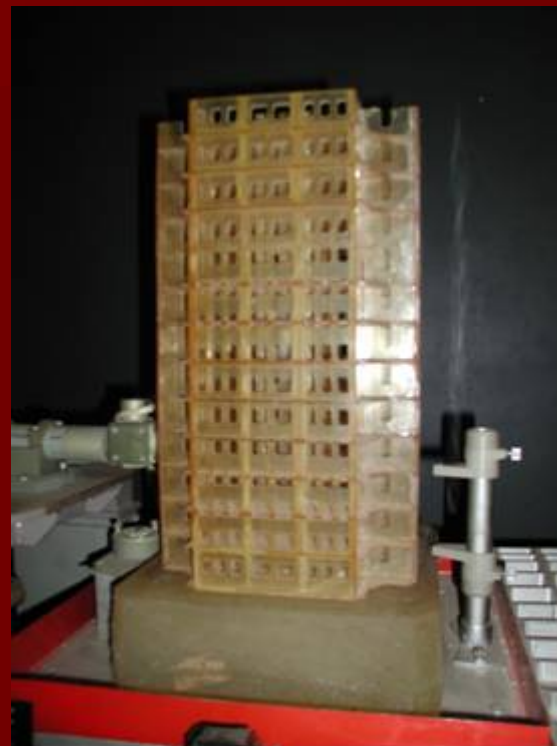
Модельная вибросейсмическая сертификация динамической устойчивости проектных решений секций и фрагментов высотных зданий и сооружений
