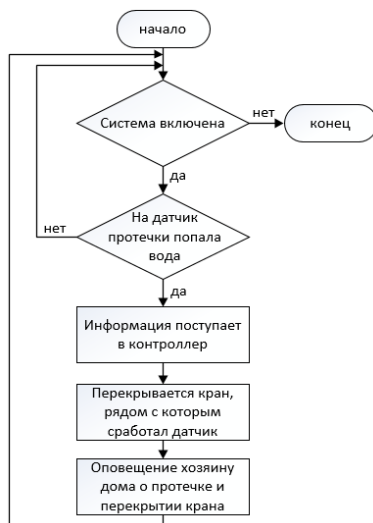
Рис.2 Схема алгоритма защиты от протечки воды.
