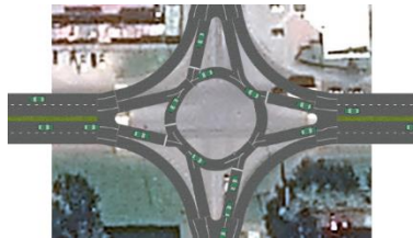
Рис. 6. Имитационная модель сложного пересечения в программе AnyLogic
