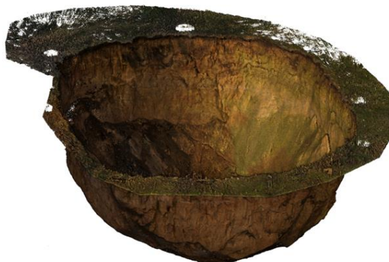
Рисунок 11. Результат съемки Нелединского провала, выполненной в 2023 году методом наземного лазерного сканирования.
