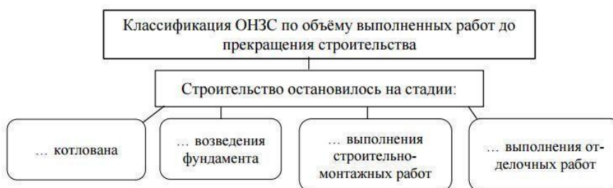
Рисунок 3. Классификация ОНЗС по объему выполненных работ до прекращения строительства [5]
