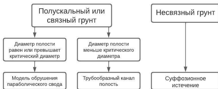
Рисунок 2. Принципиальная схема вычисления расчетного диаметра карстовой деформации
