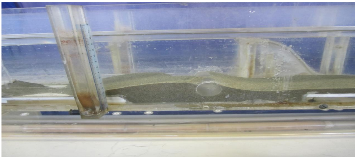
Рисунок 3.8 – Намыв песка над цилиндром ( t = 180 мин)
