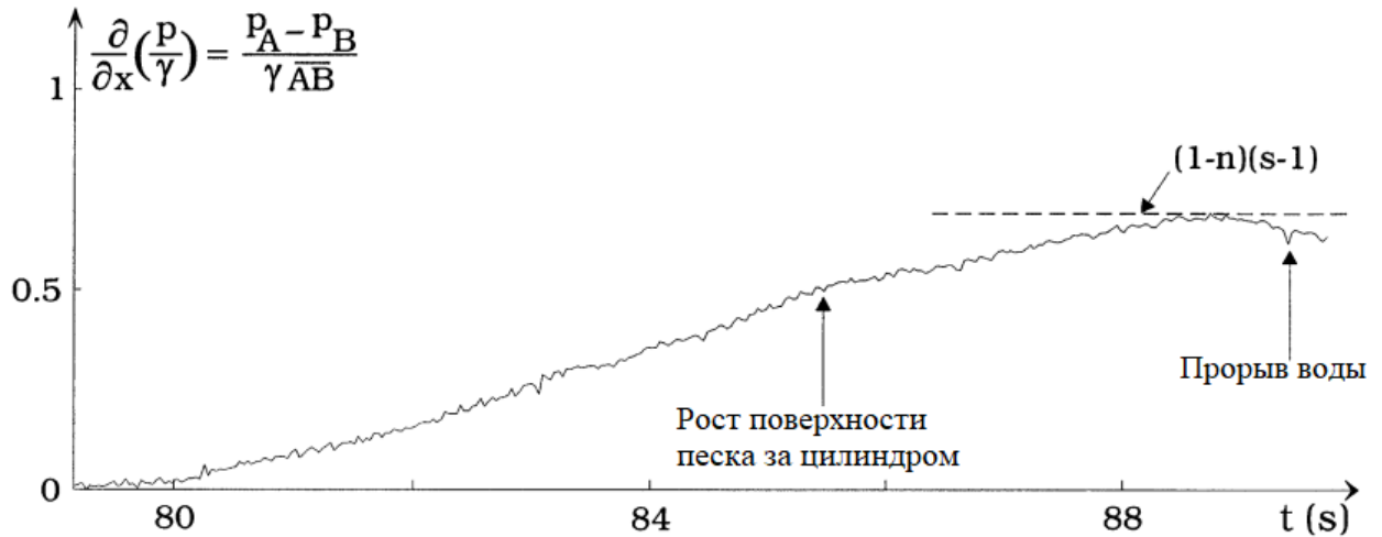
Рисунок 2.9 – Результаты экспериментов [103]. Изменение градиента давления под трубой во времени
