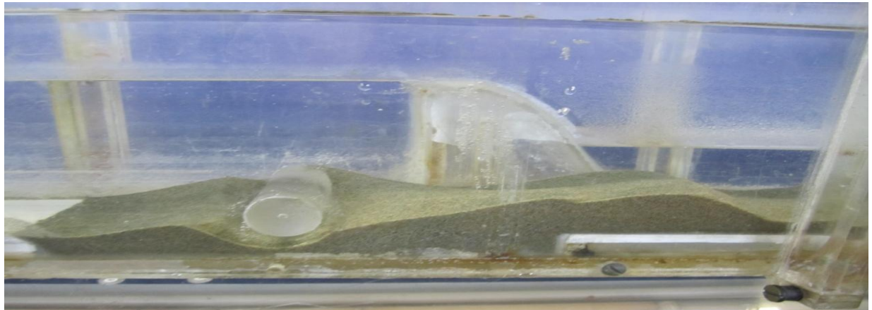
Рисунок 3.15 – Образование сквозной полости под цилиндром ( t = 780 мин)
