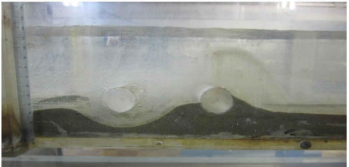
Рисунок 3.23 – Смещение гряды ко второму цилиндру ( t=15 мин)
