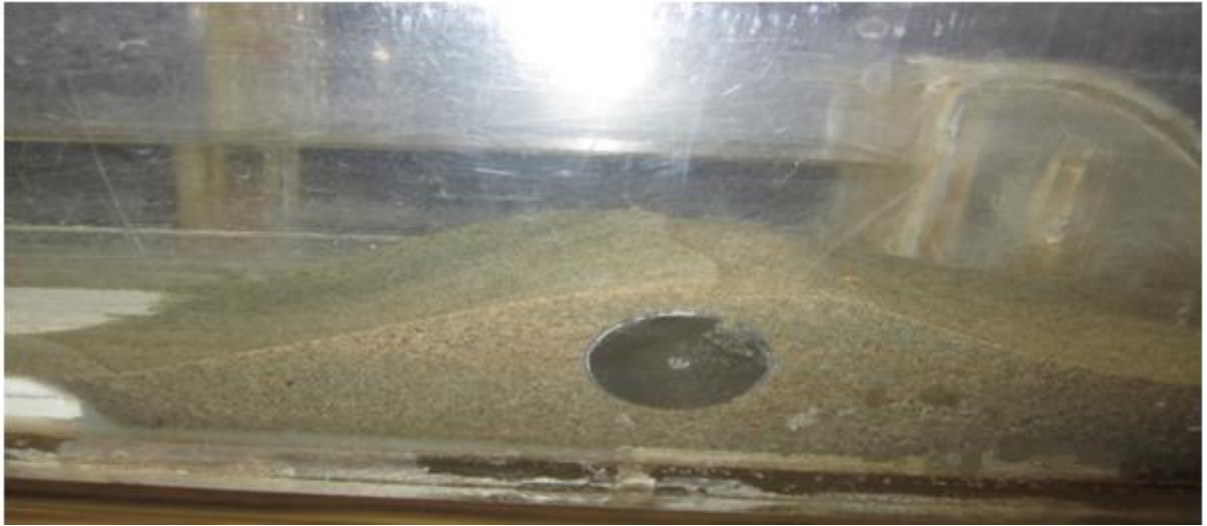
Рисунок 3.10 – Гряда полностью засыпала цилиндр ( t = 330 мин)
