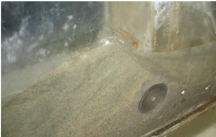
Рисунок 3.19 – Гряда достигла цилиндра ( t = 180 мин)
