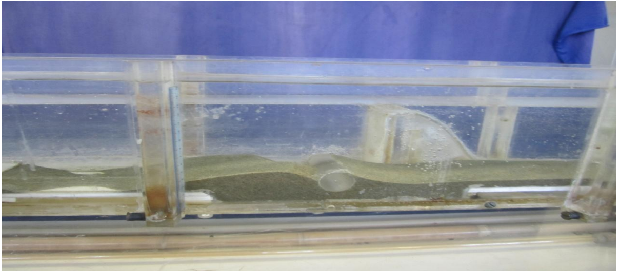
Рисунок 3.6 – Подмыв цилиндра с напорной стороны ( t = 120 мин)
