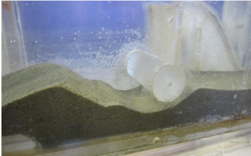
Рисунок 3.18 – Формирование донной гряды ( t = 50 мин)
