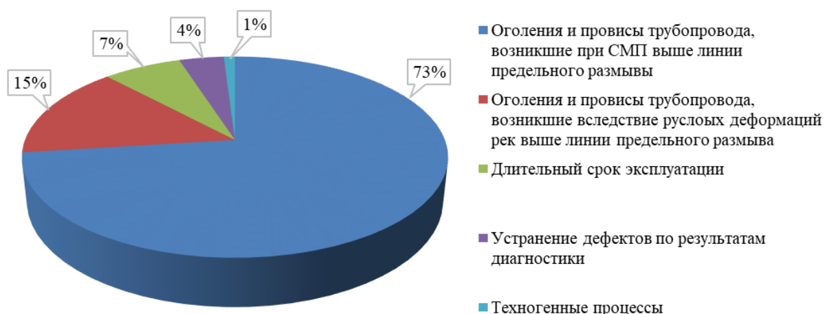
Рисунок 1.4 – Основные причины, которые приводят к капитальному ремонту подводных трубопроводов
