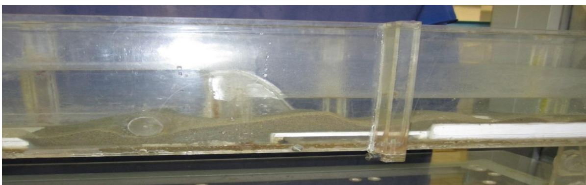
Рисунок 3.14 – Гряды с тыловой стороны ( t = 700 мин)
