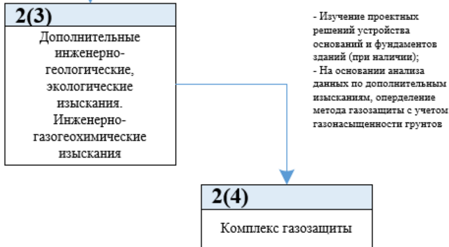
Рисунок 18 – Фрагмент диаграммы выбора комплекса газозащиты
