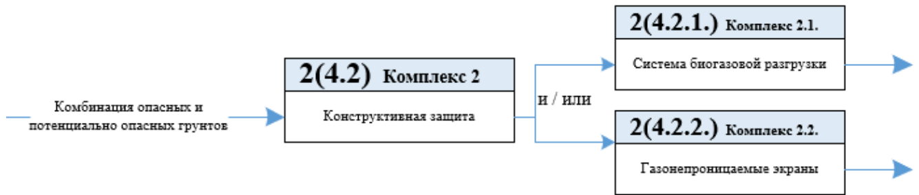
Рисунок 20 – Фрагмент диаграммы выбора Комплекса 2.1 и Комплекса 2.2
