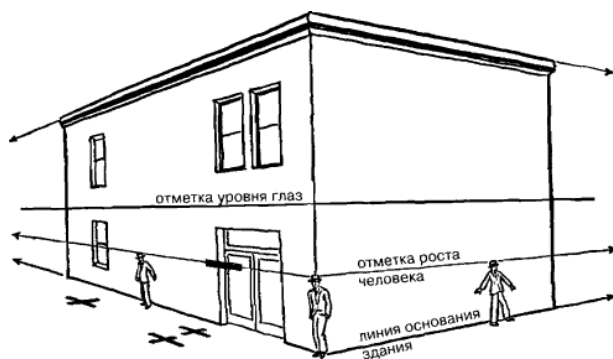
Рис 1. Основные архитектурные отметки
