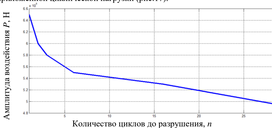
Рис. 17. Зависимость количества циклов до разрушения железобетонного узла от амплитуды приложенной циклической нагрузки
