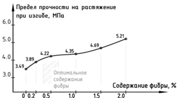
Рис. 2. Зависимость прочности на растяжение при изгибе от содержания полимерной фибры
