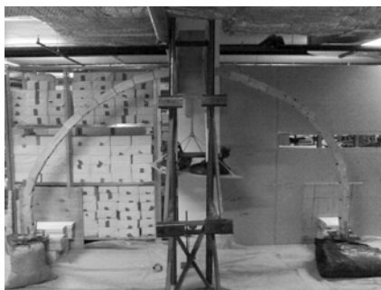
Рис. 2. Изменение формы арки в процессе деформации
