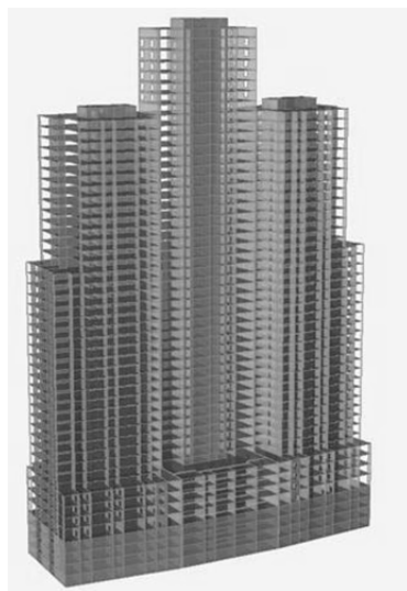
Рис.2б. Конечно-элементная 3D модель в ПК «SOFiSTiK AG»
