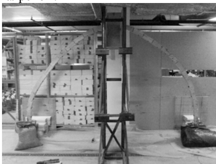
Рис. 1. Исходная преднапряженная арка с обратным выгибом
