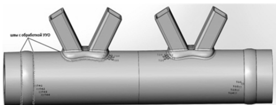
Рис. 2. Схема образца и расположение тензорезисторов
