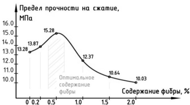
Рис. 1. Зависимость прочности на сжатие от содержания полимерной фибры
